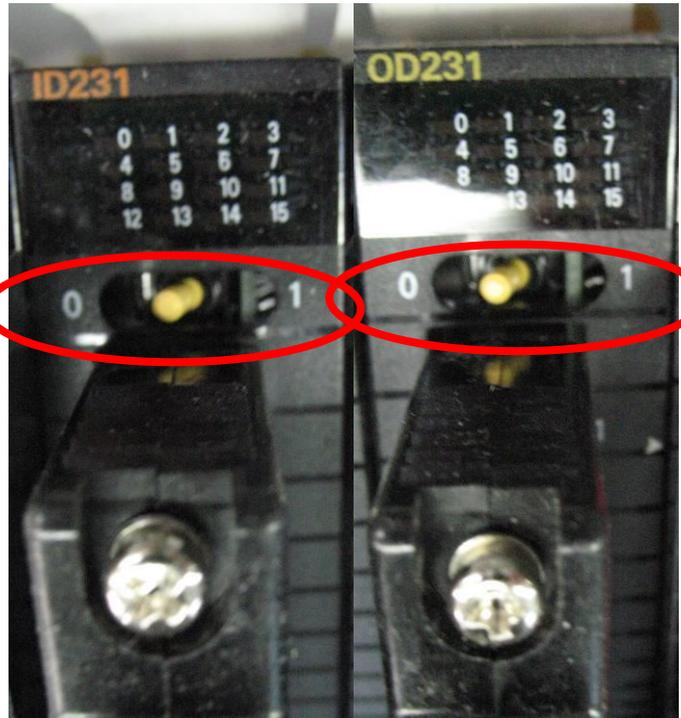
Par exemple, pour visualiser l'entrer TSTD, il faut vérifier la « DEL2 » sur le module ID231 avec l'interrupteur à droite (1).
